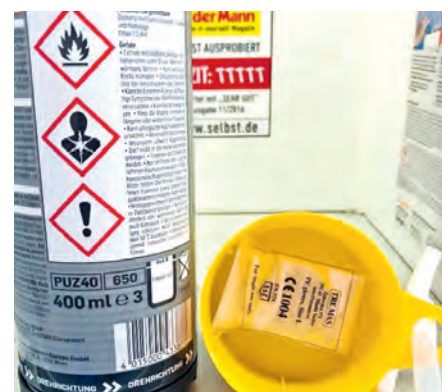
Abb. 4: Handschuhe im Deckel einer PU-Schaum-Dose
